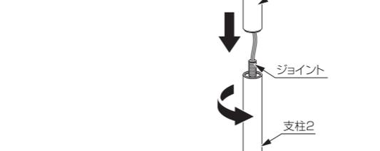
コードが振れていくと断線の恐れがあるため、必ず下に取り付ける支柱を回してください。
