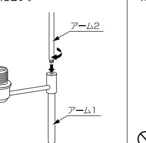
アーム1を手で持ち、ジョイントを穴に合わせ、支柱を左に回して固定してください。
