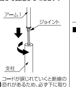
○ コードが捩じれていくと断線の恐れがあるため、必ず下に取り付ける支柱を回してください。
