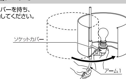
变形の恐れがあるため布セードを持って可動させないでください。点灯中は可動させないでください。可動させる時は消灯し、温度が低くなってから可動させてください。
