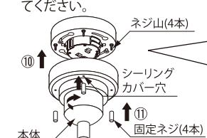
この時にネジ山をシーリングカバー穴に通す位置で角度を調整します。
