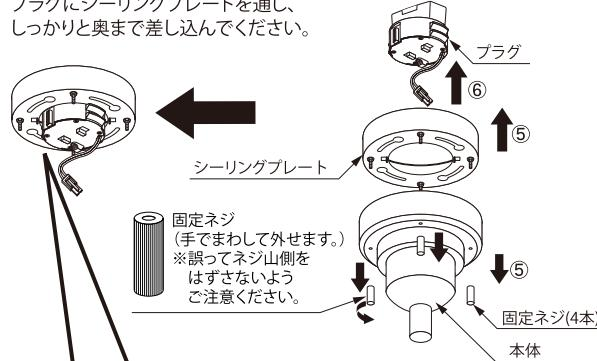
天井配線器具によって取り付け完了時のプラグの位置が違います。
